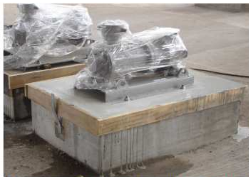
Tekutá zálivka PCI Vergussmörtel umožňuje vytvoření pevného spojení bez trhlin a dutin a tím napomáhá klidnému chodu strojů a jejich dokonalé funkčnosti při minimálním opotřebení.
